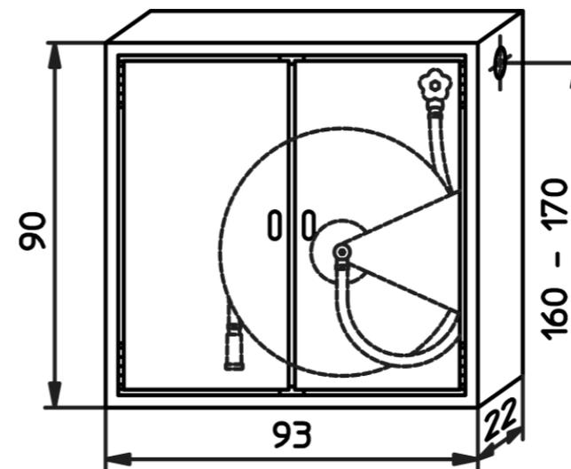
Feuerlöschposten mit Kasten rostfrei, V2A, geschliffen, 2-türig, Platz für 1 Löscher, Tiefe 22 cm mit Kunststofftrommel, Haspel-Scheiben Ø 61cm rostfrei, Schlauch PVC beige Ø 19/27mm, Verbindungsschlauch G1" Innengewinde, links und rechts aufrollbar, links und rechts montierbar. Ohne Strahlrohr, ohne Feuerhahn. Für Auf- und Unterputzmontage.
